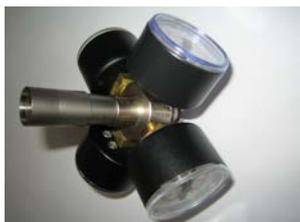
Надеть контрольный манометр Sirona Prüfstern на быстросменную муфту Sirona.
