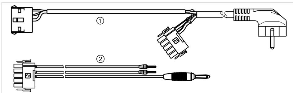
С помощью измерительного провода ① установка отключается от сети заказчика и подключается к прибору для проверки безопасности. При этом провод для подсоединения к сети заказчика L & N не должен отсоединяться от платы входного напряжения. Переходный кабель ② поставляется вместе с измерительным проводом KaVo и применяется для более ранних моделей стоматологических установок, не оснащенных соединительным штекером X2.
