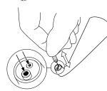
Загрязнения в отверстиях выхода сред осторожно удалите короткой иглой для прочистки форсунок.
